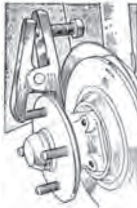
شکل ۲۶- نحوه خارج کردن پیچ چرخ به کمک سیبک کش
