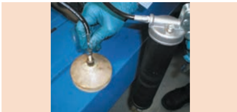
شکل ۲۲- روش گریس کاری به کمک دستگاه مخصوص
