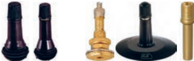
انواع ولو بدون تیوب (تیوب لس)
