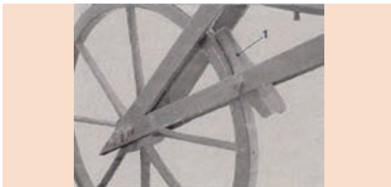
شکل ۱- نمونه ترمزهای اولیه ۱۸۲۰ میلادی
