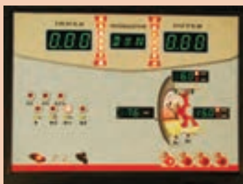
صفحه نمایش دو نوع دستگاه بالانس دینامیکی
