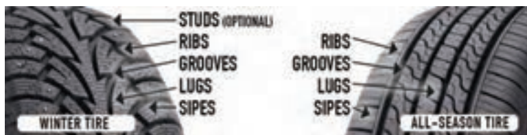
شکل ۲- مقایسه تایر چهار فصل و تایر برفی
