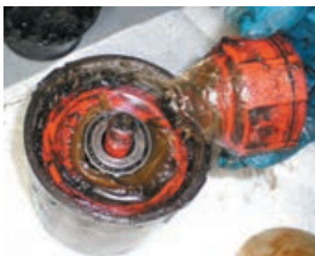
شکل ۲۱- روش گریس کاری به کمک مخروط های مخصوص
