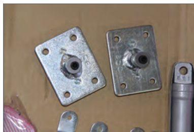
قطعه محور مرکزی نصب پمپ بر روی بدنه ها
