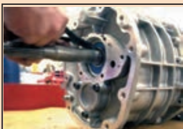
خارج کردن خار پشت بلبرینگ محور ورودی
