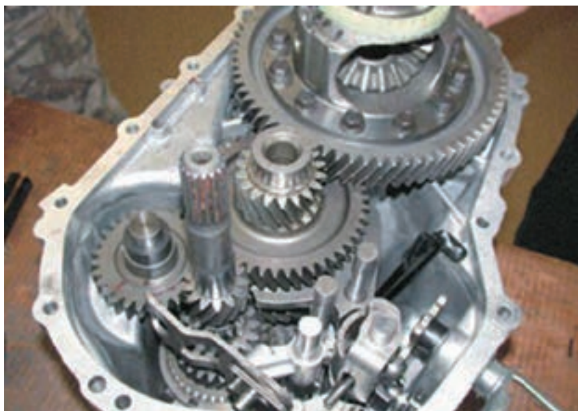
شکل ۱۳- دیفرانسیل در جعبه دنده جلو محرک
