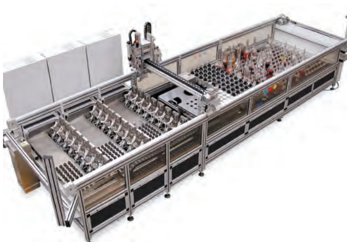
شکل ۲ - بخشی از سیستم اتوماسیون‌سازی آزمایشگاه رنگری
