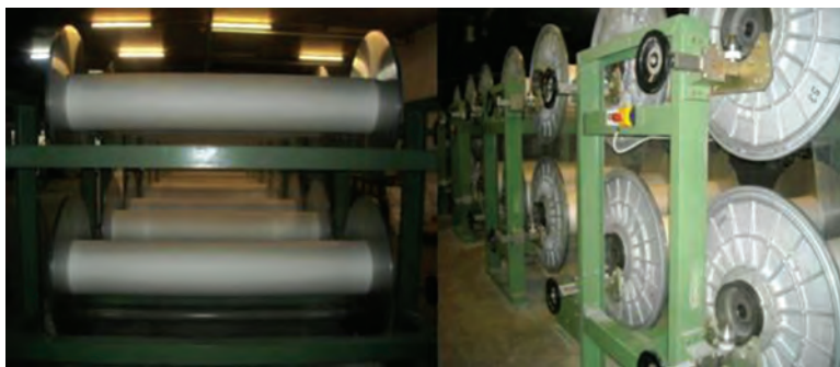
شکل ۳- نوردهای آهار و دستگاه آهارزنی
