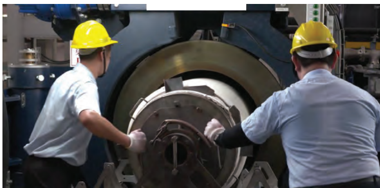
شکل ۱- تصویری از ماشین رنگ‌رزی بدون آب
