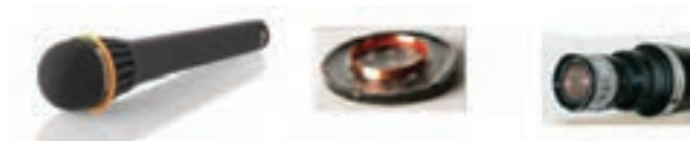
شکل ۳۶- اجزای میکروفون داینامیکی
