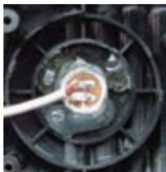
شکل ۴۰- یک نمونه اتصال درست سیم به پایه‌های کپسول میکروفون خازنی
