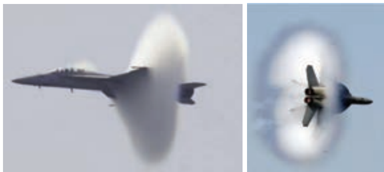
شکل ۱- در این شکل اثر چگالش بخار آب تحت تأثیر فشار و پدیده شکست دیوار صوتی مد نظر است.
