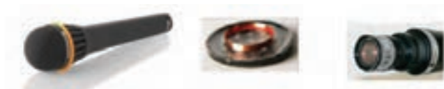
شکل ۳۶- اجزای میکروفون داینامیکی
