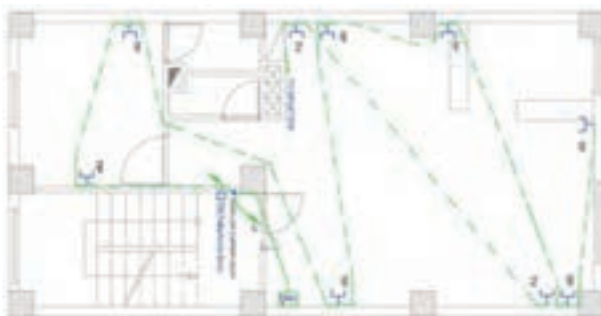
شکل ۸- پریز برق و تلفن در ترانکینگ
