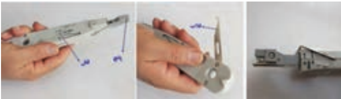
شکل ۳- اجزای مختلف دستگاه پانچ زن
