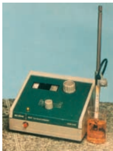
شکل ۱۳ - ۲ دستگاه EC متر
