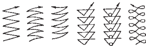
شکل ۳-۳۲- حالت‌های مختلف حرکت نوسانی نوک الکتروود
