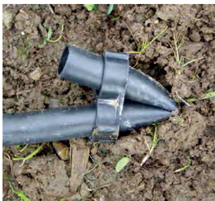
بست عینکی (بستن انتهای لوله)
