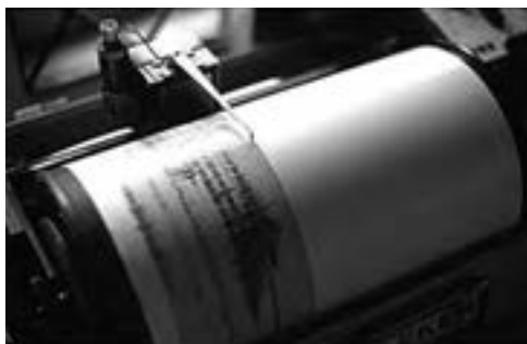
لرزه نگار دستگاهی است که نوسانات زمینی ناشی از ورود امواج لرزه ای را همراه با علائم بسیار دقیق زمانی ثبت می کند.
