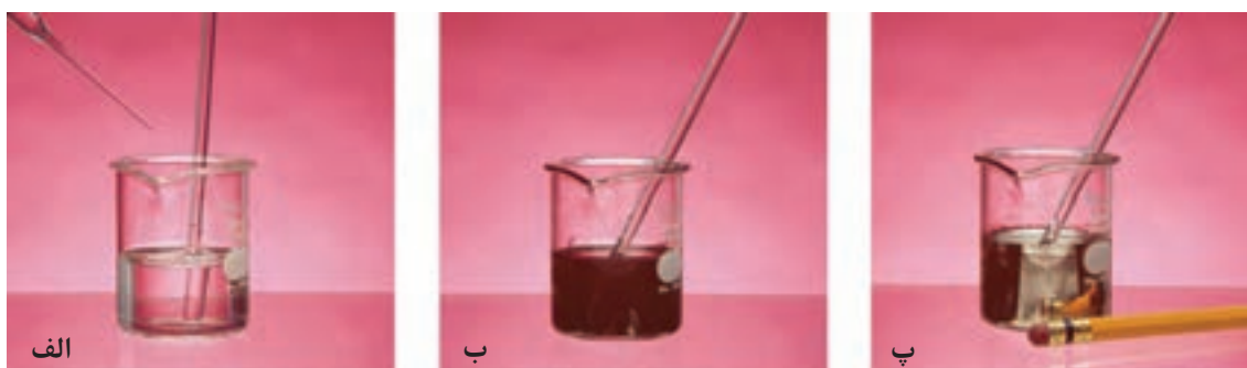
شکل ۴- الف - محلول اتانول به محلول آمونیاکی نقره نیترات افزوده می‌شود. ب - محلول تیره که اتانول به اتانویک اسید اکسید شده و یون نقره به نقره کاهش می‌یابد. پ - دیواره بشر با فلز نقره پوشیده شده است.
