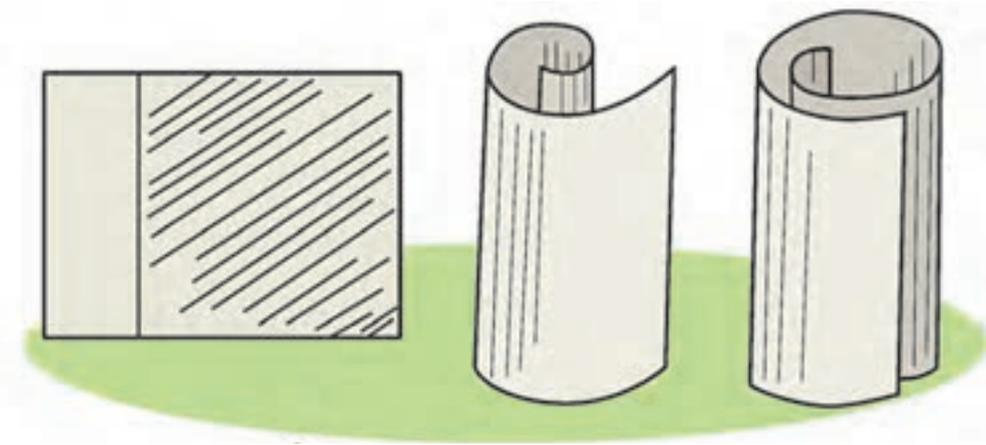
برای اتصال سرهای توخالی به لوله‌ی گردن بهتر است که بالای لوله به وسیله‌ی برش لوله و چسباندن سطوح بریده‌شده به هم، مسدود شود.
