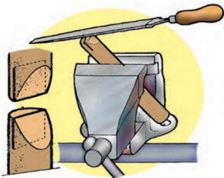
اکنون سطح مقطع هرکدام از آن‌ها را به اندازه‌ی ۲ سانتی‌متر با اره شکاف می‌دهیم، قطعه چرمی را انتخاب و پس از آغشته کردن آن به چسب چوب درون شکاف قرار می‌دهیم و برای محکم شدن به هرکدام از قسمت‌های آن دو عدد میخ می‌کوبیم.
