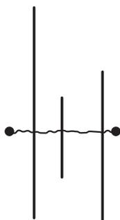
ب - اتصال پایونی: در این روش نخست قطعه مفتول نازکی را به شکل پروانه یا پایون درمی‌آوریم. سپس با قرار دادن واشر در میان قطعات مورد نظر، قطعه مفتول را از سوراخ آن‌ها عبور داده و در طرف دیگر برمیگردانیم. از میخ‌های سراجی دو سر تیز می‌توان استفاده کرد.
