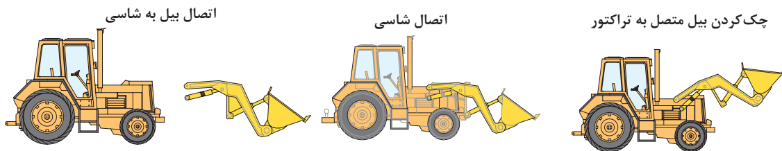
جدول ۴-۷- مراحل اتصال بیل به تراکتور
