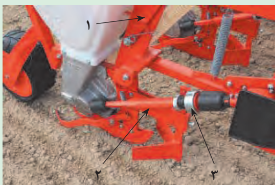
شکل ۳-۲۷. حذف واحد کارنده در یک نمونه ردیف‌کار
