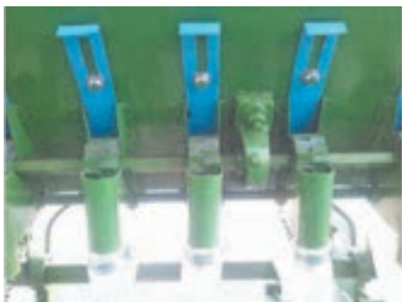
شکل ۳-۲۶. دریچه تغذیه در خطی کار
