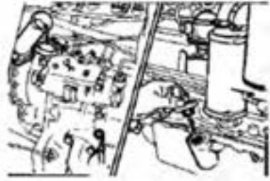
سطح روغن موتور را کنترل کنید.
