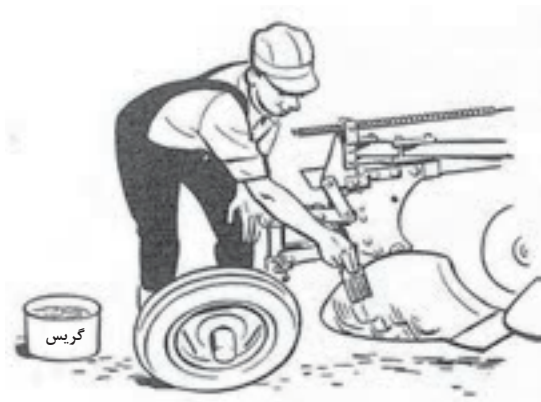
شکل ۵۲-۱. اندود کردن قطعات گاوآهن با مواد ضدزنگ
