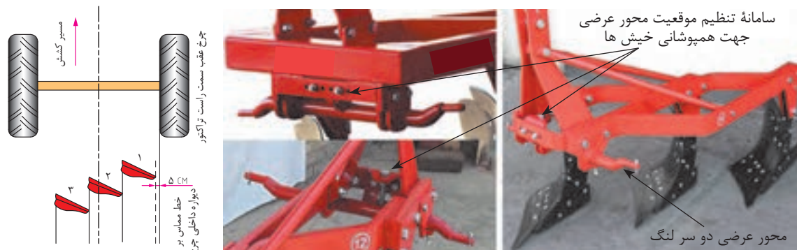
شکل ۲۸-۱. تنظیم هم پوشانی (عرض کار) در گاواهن برگردان دار
