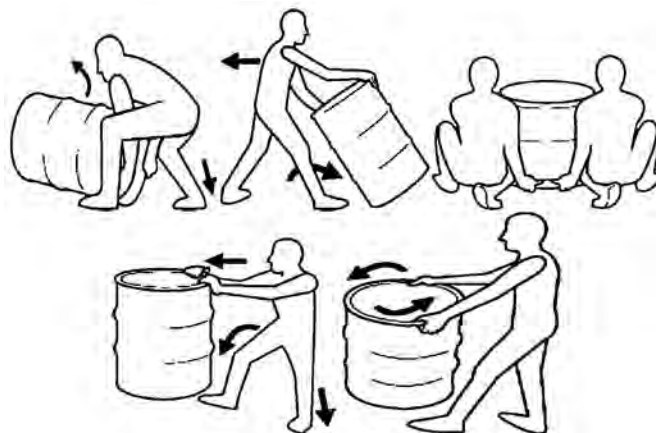
شکل ۲۴-۱- جابه‌جایی صحیح بارهای سنگین
