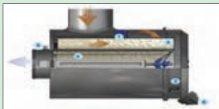
شکل ۲۳-۲- مسیر عبور هوا در صافی روغنی
