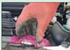
شکل ۴۳- ۲- باز کردن درب رادیاتور
