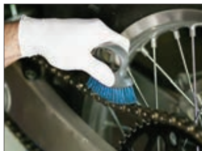
شکل ۱۴-۲- تمیز کردن زنجیر
