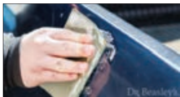
شکل ۱-۶۲- سنباده زدن ورق آهن
