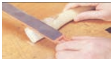
شکل ۱-۶۳- سنباده زدن چوب
