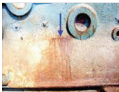
شکل ۴۴- ۲- ترک‌یدن بلوک سیلندر در اثر سرما
