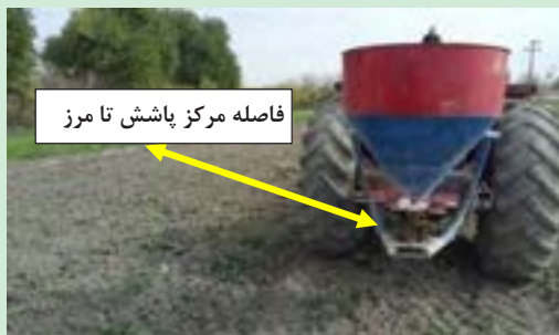
شکل ۱۹- کنترل فاصله پاشش بذر
