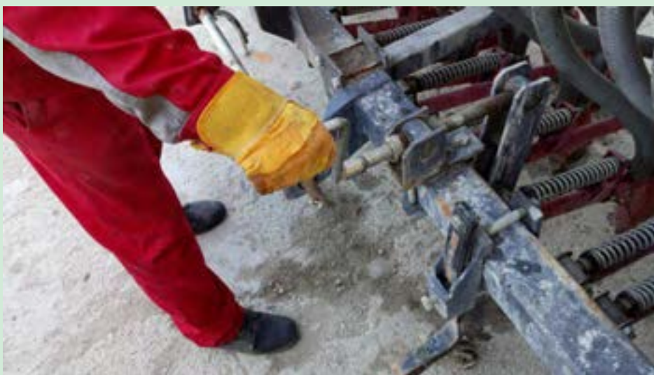
شکل ۲۱- تنظیم عمق کاشت
