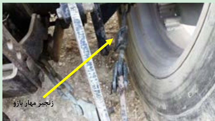
شکل ۲۴- زنجیر مه‌ار. برای تنظیم تعادلی
