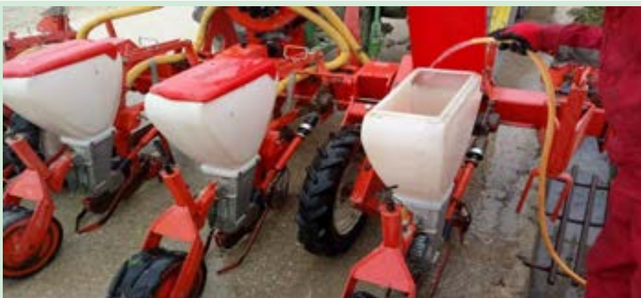
شکل ۱۱- شستشو و تمیز کردن ماشین ردیف‌کار
