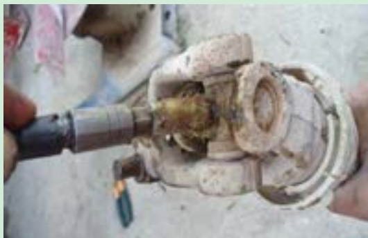
شکل ۱۵- گریس کاری گاردان و بذریاش
