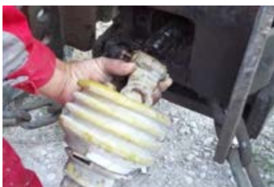
شکل ۱۱- اتصال گاردان به تراکتور
