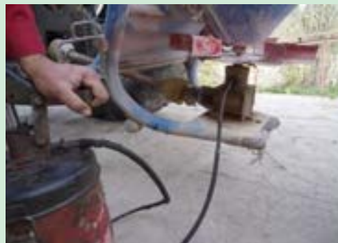
شکل ۱۵- گریس کاری گاردان و بذریاش
