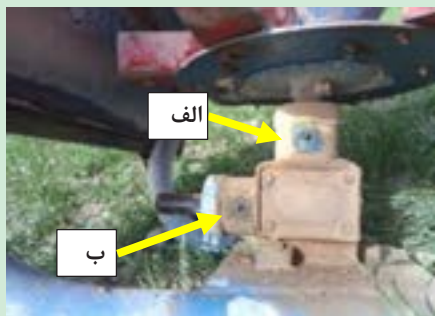
شکل ۱۳- تمیز کردن گریسخورها و مکان آنها
