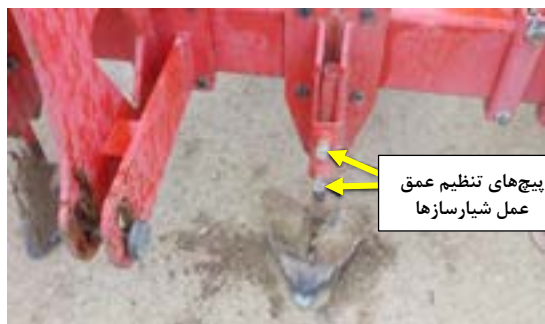
شکل ۱۷ - پیچ‌های تنظیم عمق شیارساز
