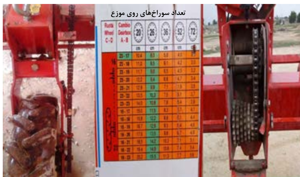
شکل ۲۵- تغییر در وضعیت چرخ دنده ها
