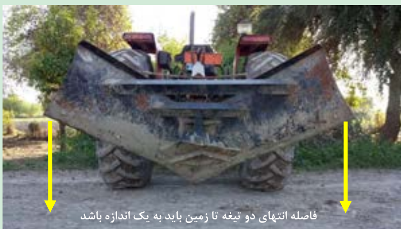
شکل ۲۵- تنظیم تراز عرضی نه‌رکن
