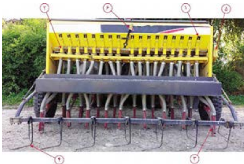
شکل ۷ - ساختمان خطی کار از عقب دستگاه
