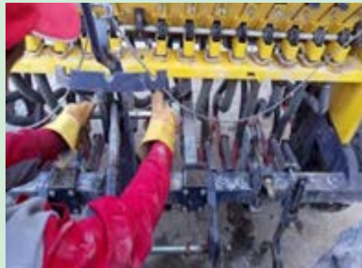
شکل ۱۳- متصل کردن خطی کار به تراکتور
