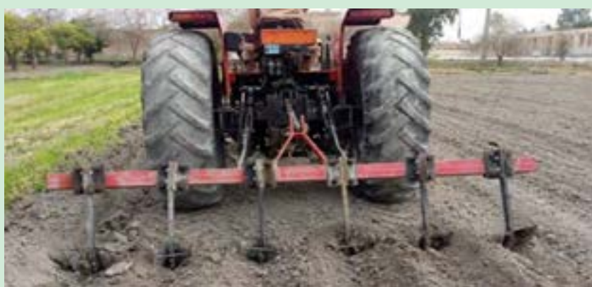
شکل ۱۵- ایجاد شیار با شیارکش
