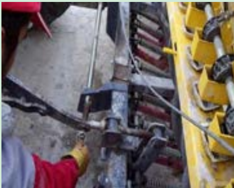
شکل ۱۳- متصل کردن خطی کار به تراکتور
