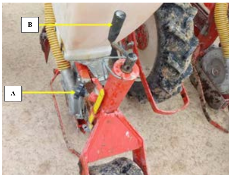
شکل ۲۱- تنظیم چرخ فشار دهنده
