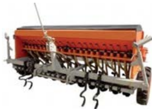
شکل ۴- خطی کار جهت کاشت غلات با قابلیت تنظیم جهت کاشت ریز دانه
