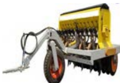
شکل ۴۹- ماشین دیم کار کششی با تک نقطه اتصال و شیلنگ های هیدرولیک
