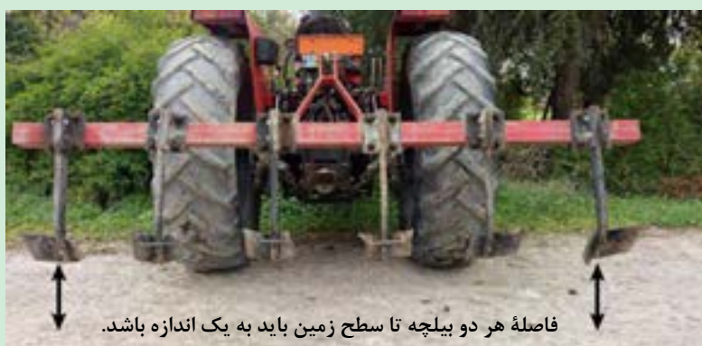
شکل ۱۴- تراز طولی شیارک
