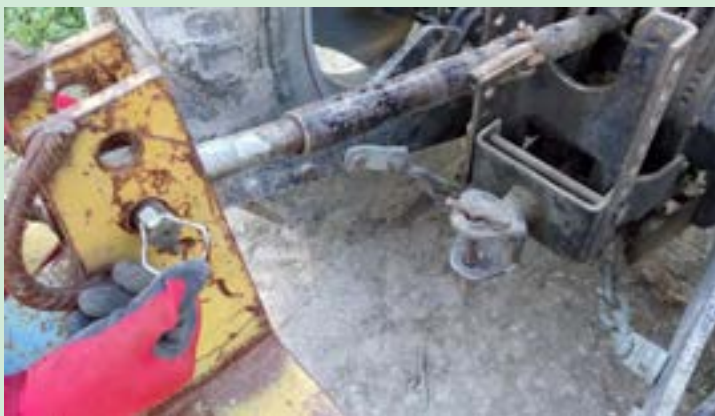
شکل ۲۳- اتصال بازوی وسط تراکتور به نه‌رکن
