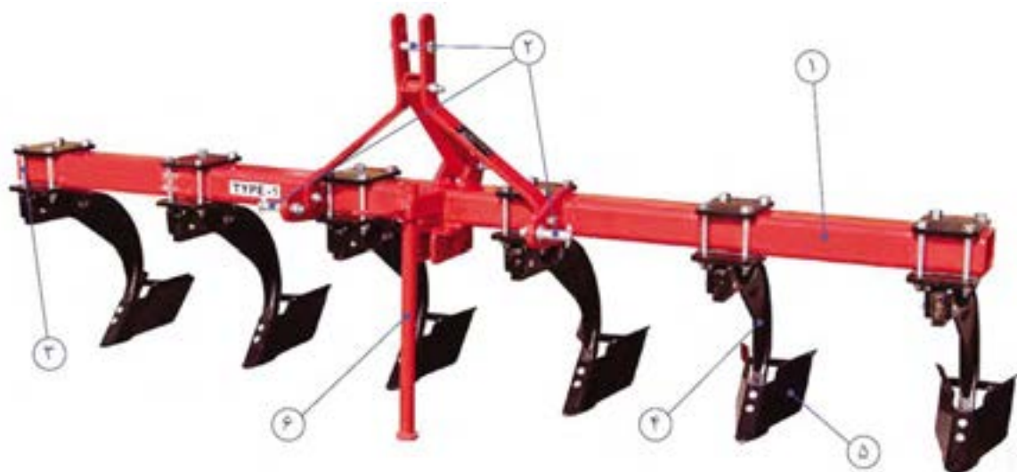
شکل ۱۳- ساختمان شیارکش
