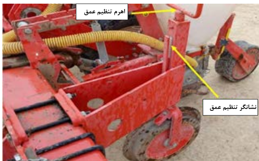
شکل ۱۸- تنظیم عمق کاشت
