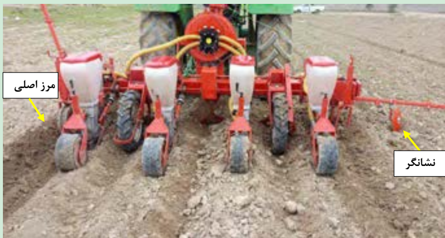
شکل ۲۷- کاشت بذر با ردیف‌کار پنوماتیکی
