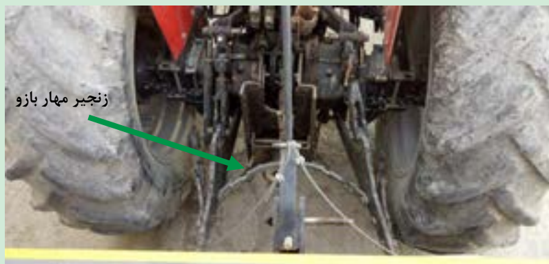
شکل ۱۴ - زنجیر مهار بازوی تراکتور
