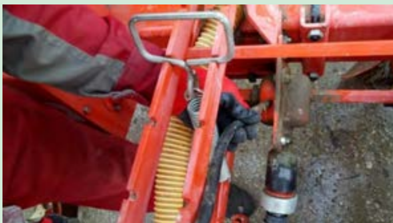
شکل ۱۲- گریس‌کاری تمام گریس‌خوره‌های ماشین ردیف‌کار
