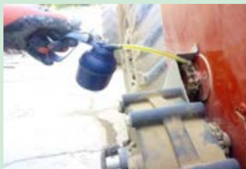
شکل ۴۳- روغن کاری چرخ دنده‌ها
