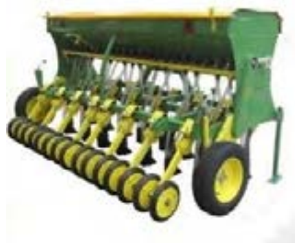
شکل ۳۳- نمونه ماشین کاشت مستقیم مکانیکی مناسب جهت کشت دیم مدل rock/3000
