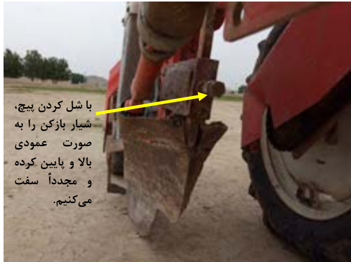
شکل ۲۰ - تنظیم شیار بازکن
