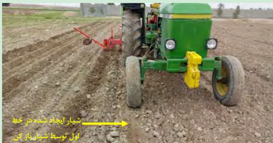
شکل ۲۸- عملیات کاشت در حالت برگشت
