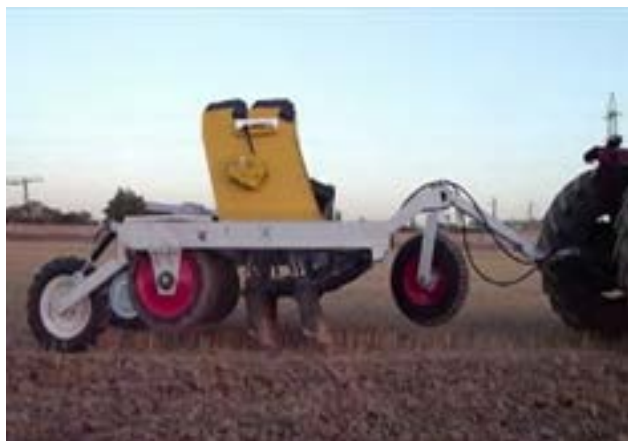
شکل ۴۷- خطی کارهای سوار و کششی در دیم‌کاری
