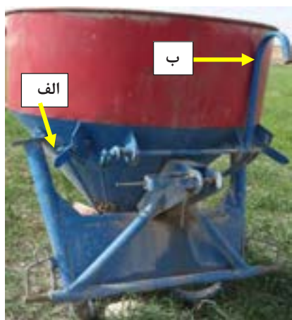
شکل ۱۸- اهرم‌های تنظیم بذر
