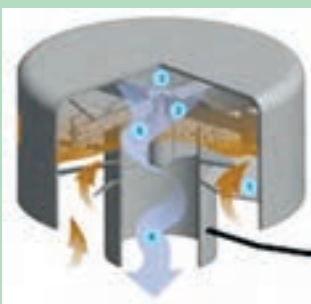
شکل ۲۵-۱ اصول کار پیش صافی
