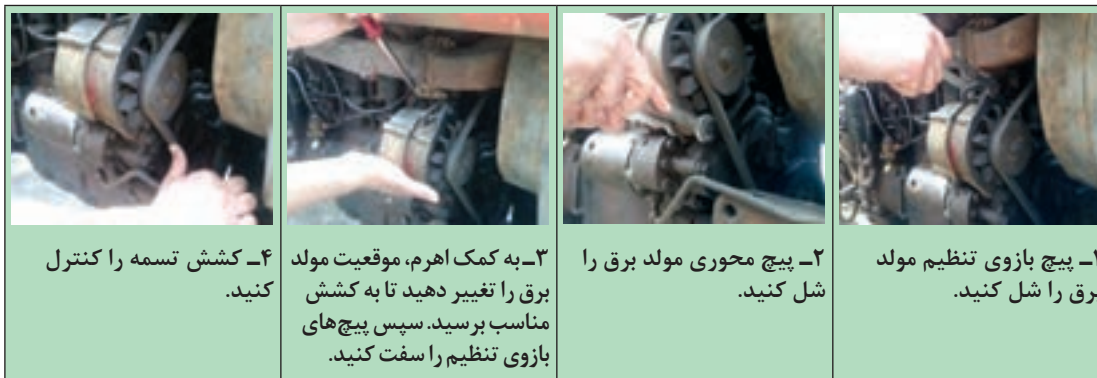
شکل ۱-۴۳- مراحل تنظیم کشش تسمه دینام
