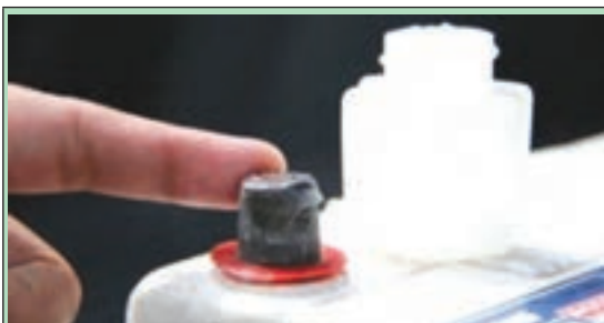
شکل ۲۰-۱- مالیدن گریس به قطب‌ها
