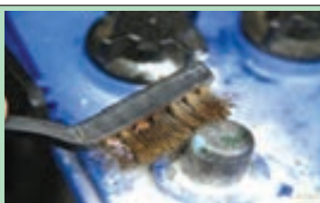
شکل ۱۷-۱- تمیز کردن قطب‌ها با برس سیمی
