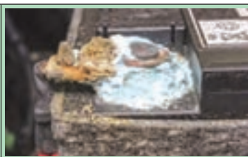
شکل ۱۶-۱- سولفات‌شدن قطب‌های باتری
