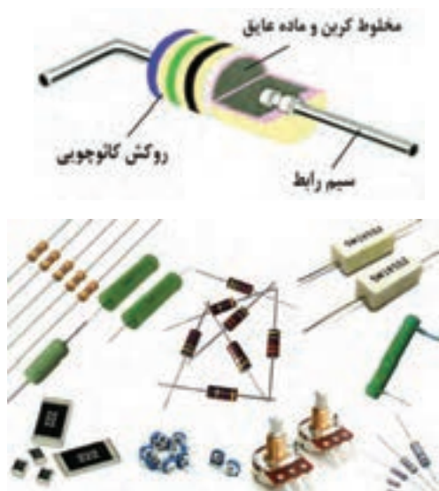
شکل ۵-۱۵ انواع مقاومت ثابت
