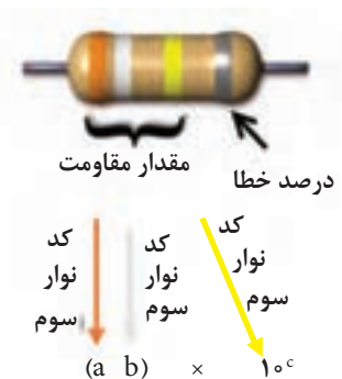
شکل ۵-۱۶ نحوه خواندن مقاومت رنگی
