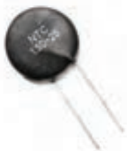
شکل ۵-۱۸ مقاومت‌های وابسته به حرارت
