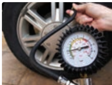
ب) اندازه‌گیری فشار هوای درون لاستیک خودرو
