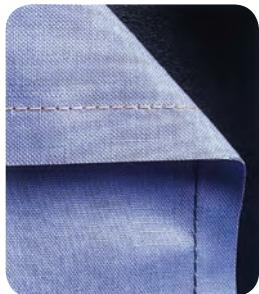
■ **دوخت صحیح:** اگر کشش نخ رویی و زیری (ماسوره) درست باشد و فشار پایه نیز متناسب با ضخامت پارچه تنظیم شود، دوختی ایجاد می‌شود که زنجیره‌های آن در میان دو پارچه قرار می‌گیرد، در این حالت طول دوخت‌ها و کشش آنها در دو طرف پارچه مساوی است.
