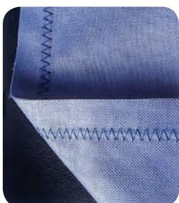
■ **دوخت روسفت:** اگر کشش نخ‌های زیر یا زیری (ماسوره) بیش از اندازه باشد، دوخت زنجیره‌ای در رو و زیر پارچه ایجاد می‌شود. (در اصطلاح دوخت دون دون است). اگر کشش نخ رویی سفت باشد کشش نخ رویی را کمی شل کرده و بر عکس اگر کشش نخ زیری سفت باشد، پیچ کنار ماسوره را کمی شل کنید.
