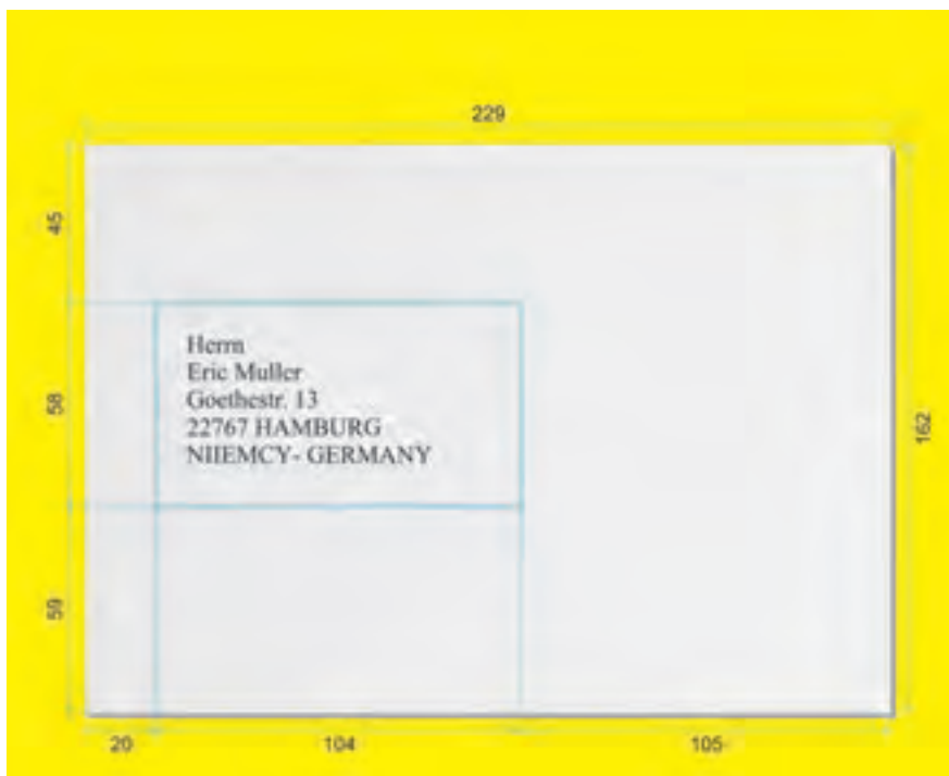
نمودار ۲۰: پاکت پستی «C۶» مطابق استاندارد «DIN۶۷۶» کشور آلمان
