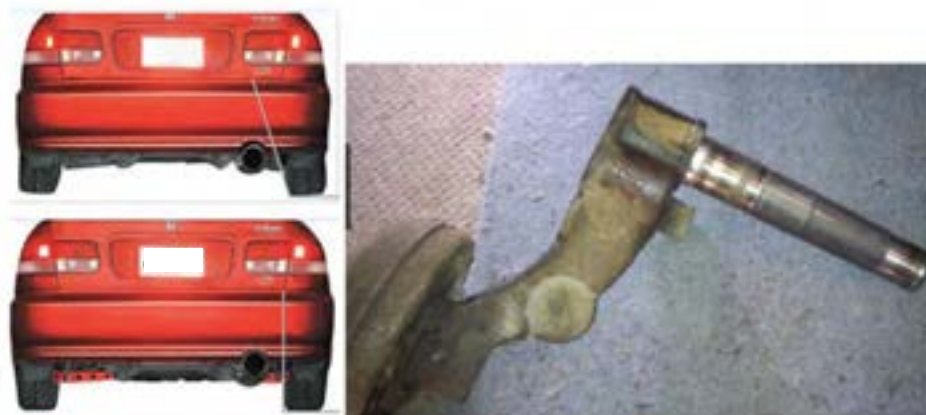
شکل ۴۶- خرابی بوش‌ها و تأثیر آن روی چرخ
