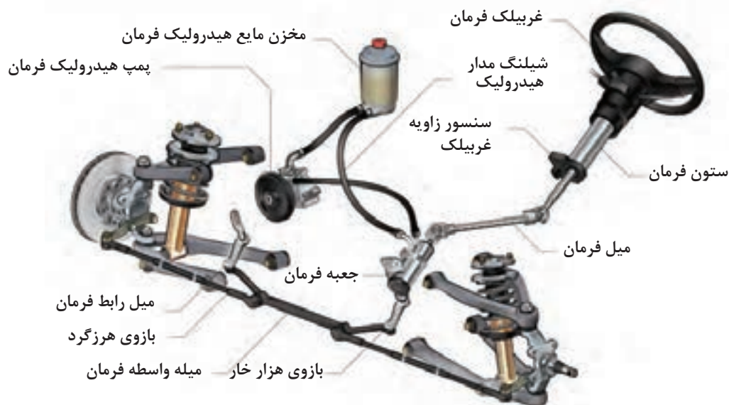
شکل ۱۶ - سیستم فرمان با توان کمکی هیدرولیکی
