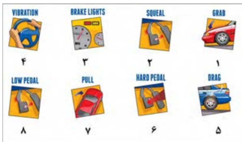
شکل ۲۱- آثار مهم خرابی سیستم ترمز
