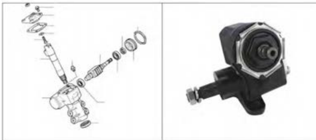
شکل ۲۹ - نوعی مکانیزم تنظیم لقی طولی مارپیچ فرمان
