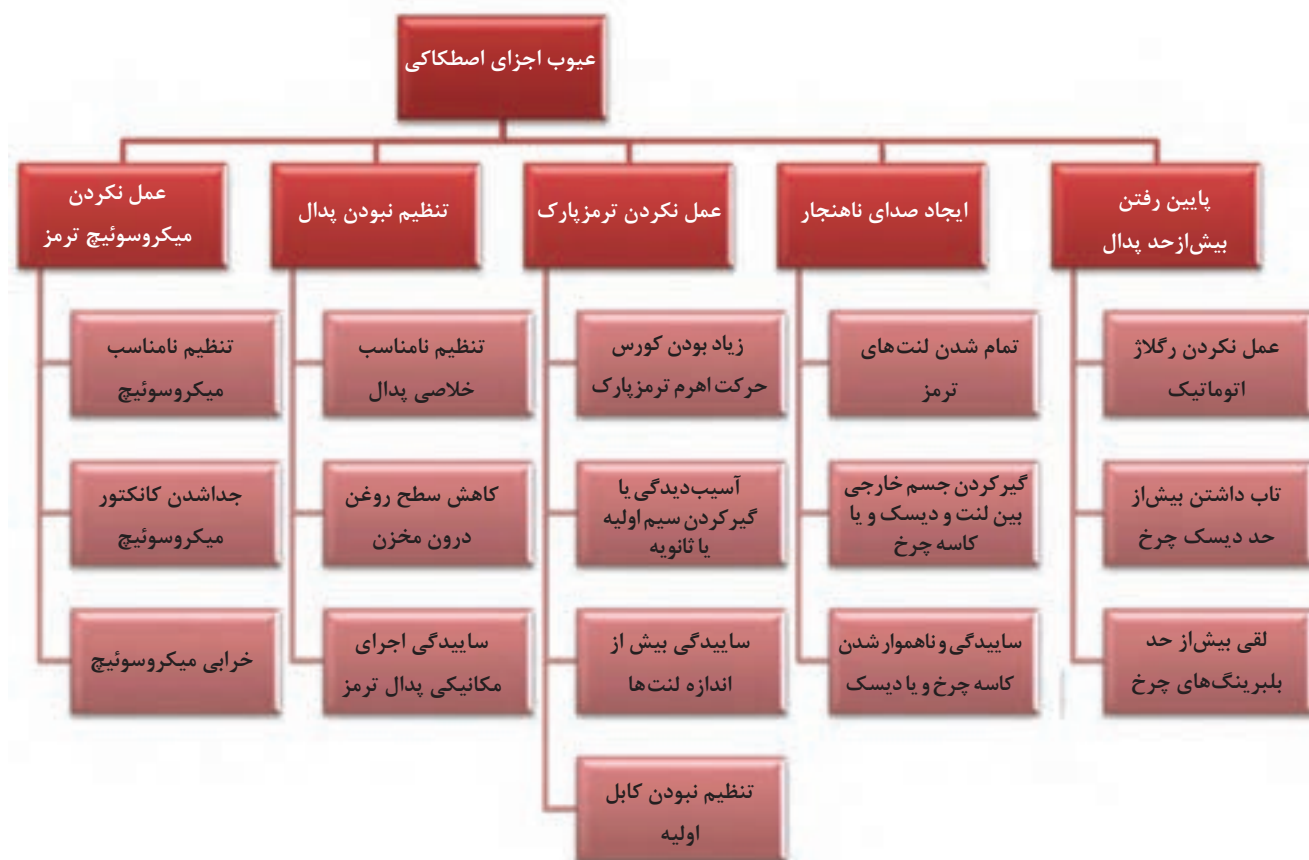
شکل ۲۳- عیوب اجزای اصطکاکی
