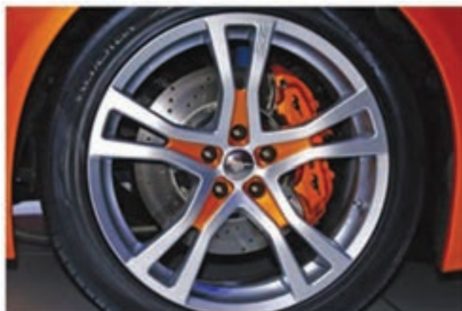
شکل ۷- رینگ در خودروهای امروزی (رینگ فاق کوتاه)
