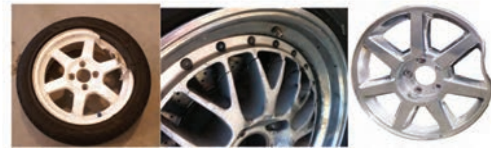
شکل ۳۴- بررسی ظاهری رینگ
