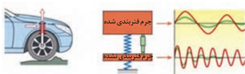
شکل ۲۷- عملکرد سیستم فنربندی تعلیق
