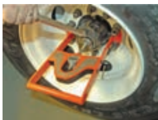
شکل ۲۱- روش تنظیم پیش‌بار بلبرینگ یا رولبرینگ
