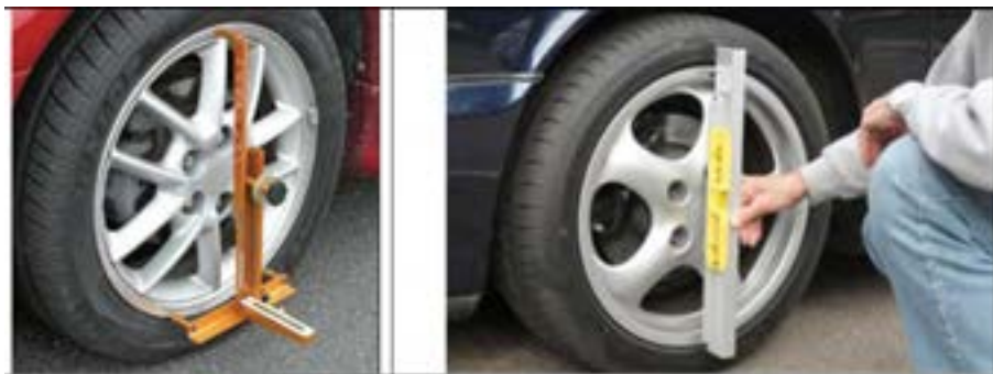
شکل ۴۳- ابزار مخصوص بررسی و تنظیم زوایای چرخ
