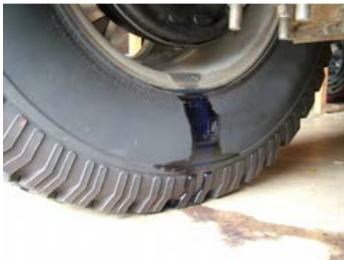
شکل ۴۱- وجود روغن اطراف چرخ عقب
