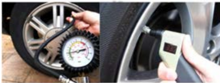
شکل ۲۰ - شیوه بررسی و تنظیم فشار باد تایر
