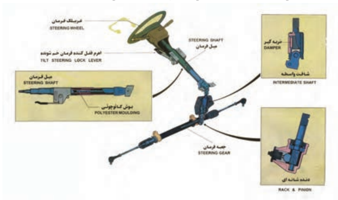
شکل ۲ - مجموعه فرمان و اجزای آن
