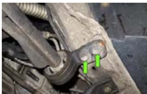
گشتاور سنجی اتصالات پیچ و مهره ای
