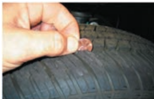
شکل ۱۶- نحوه اندازه‌گیری تقریبی شیار تایر
