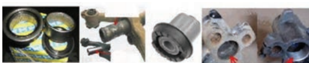
شکل ۴۵- قطعات تعلیق با بازوی کشنده
