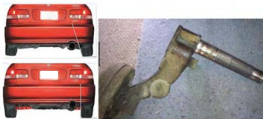
شکل ۴۶- خرابی بوش‌ها و تأثیر آن روی چرخ
