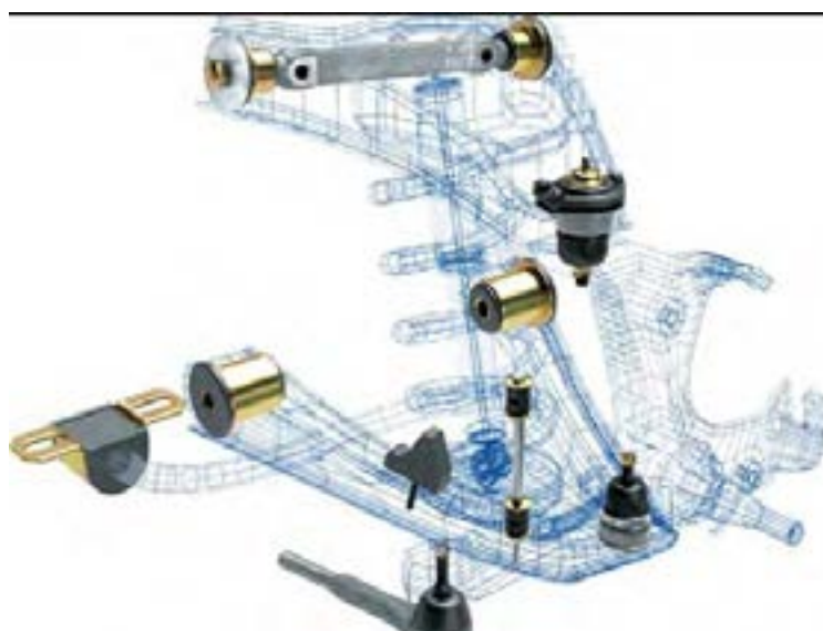
شکل ۱۲- انواع اتصالات لاستیکی
