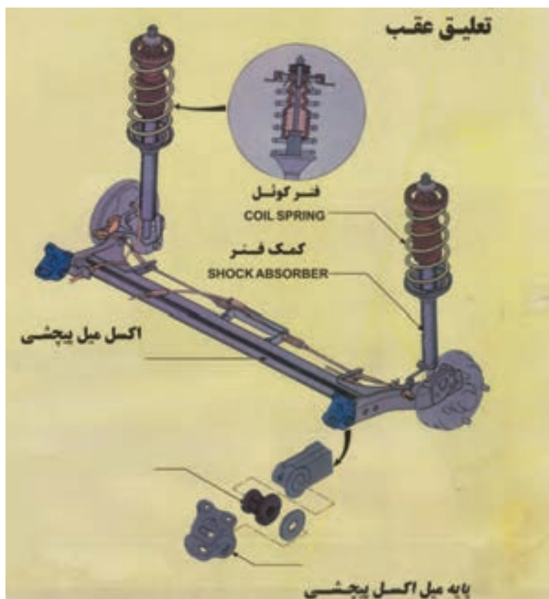
شکل ۴۹- تعلیق با اکسل میل پیچشی
