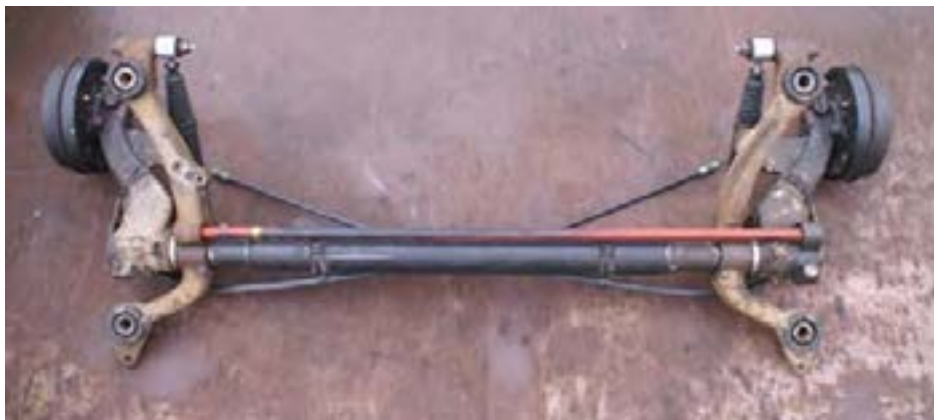
شکل ۴۴- مجموعه تعلیق عقب میله کشنده
