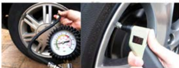
شکل ۲۰ - شیوه بررسی و تنظیم فشار باد تایر
