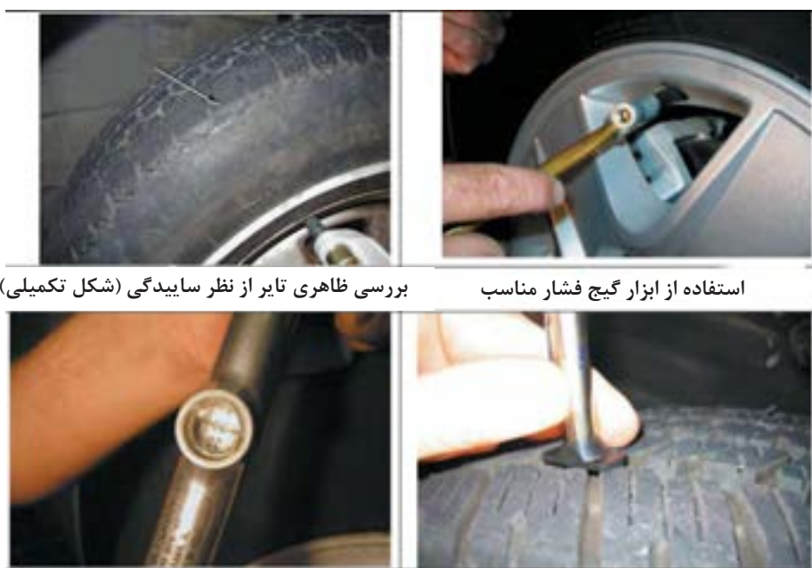
شکل ۱۵- مراحل بررسی تایر
