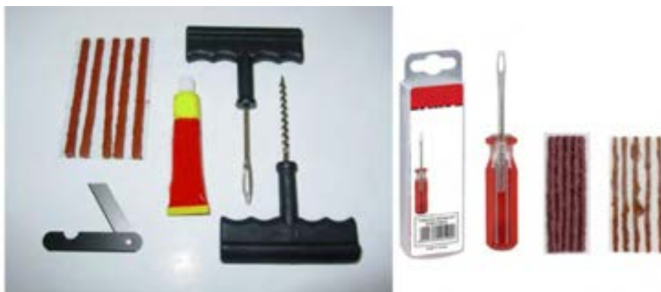
شکل ۲۵- ابزار مخصوص پنچرگیری تایر بدون تیوب (تیوبلس)
