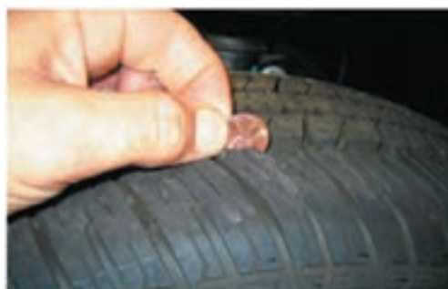
شکل ۱۶- نحوه اندازه‌گیری تقریبی شیار تایر
