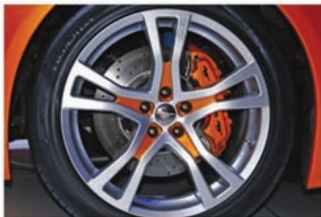
شکل ۷- رینگ در خودروهای امروزی (رینگ فاق کوتاه)
