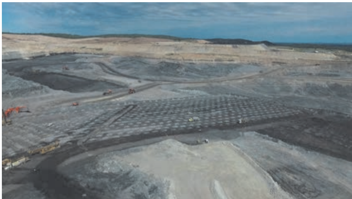
شبکه چال آتشیاری حفر شده
