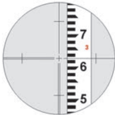
تارهای رتیکول داخل دوربین نقشه برداری
