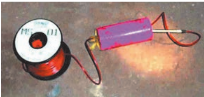
طریقه قرار دادن چاشنی درون دینامیت
