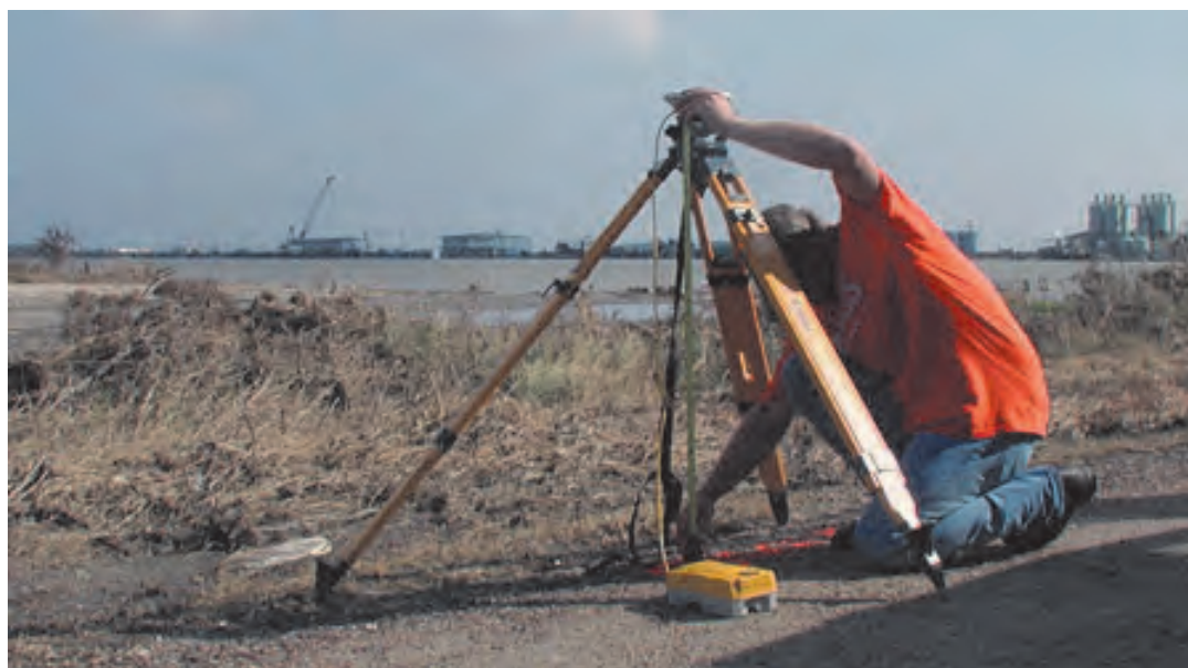
اندازه گیری ارتفاع دوربین تا سطح زمین
