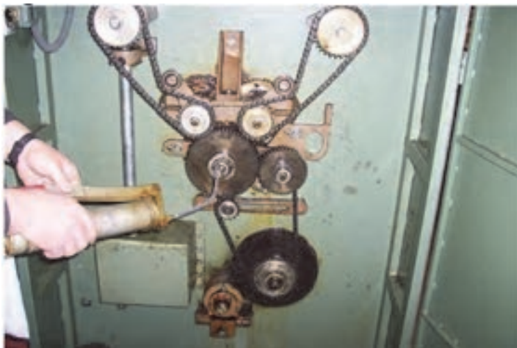
شکل ۱۷ روغن کاری و گریس کاری زنجیرها
