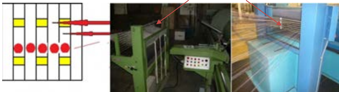
شکل ۱۳ شانه مقسم یا متحرک
