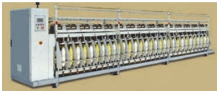
شکل ۱۴ یک نمونه دستگاه دولا تاب رینگ
