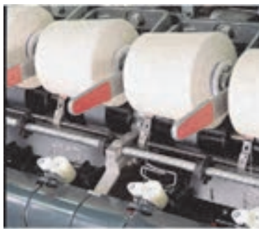
شکل ۲۵ راهنمای متحرک پیچش نخ (تراورس)
