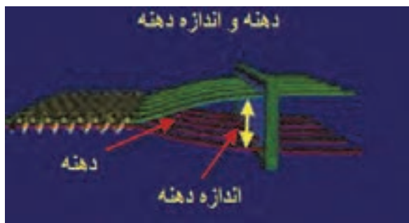
شکل ۴۴ تشکیل دهنه و اندازه آن
