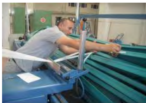
شکل ۲۲ وصل کردن نخ‌ها به میخ روی درام
