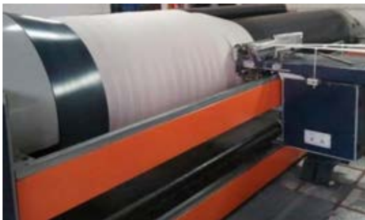
شکل ۱۲ ماشین چله پیچ بخشی
