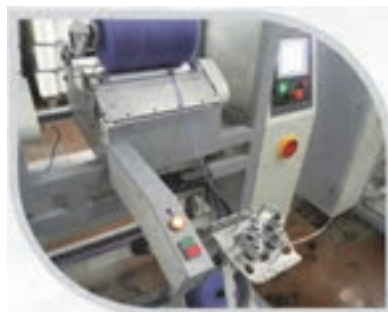
شکل ۴ پولکی‌های کشیدگی نخ
