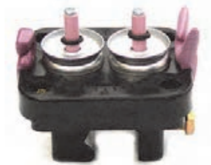
شکل ۳۶ دستگاه کشیدگی نخ با صفحه و فنر
