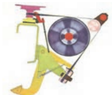
شکل ۲۹ تجهیزات ترمز گرفتن دوک
