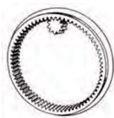
شکل ۴۱-۵ چرخ دنده متداخل
