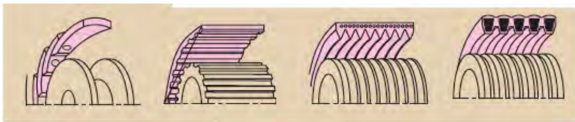
شکل ۳۰-۵ انواع شیار تسمه و پولی
