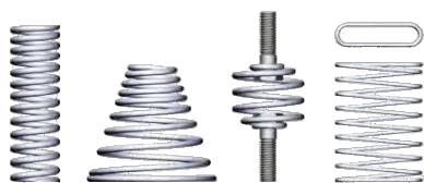
شکل ۴۷-۵ انواع فنر فشاری
