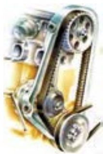
شکل ۲۸-۵ کار برد چرخ و تسمه در موتور خودرو
