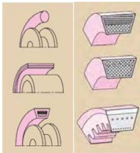
شکل ۲۹-۵ انواع سطح مقطع تسمه و پولی
