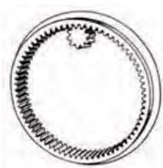
شکل ۴۱-۵ چرخ دنده متداخل
