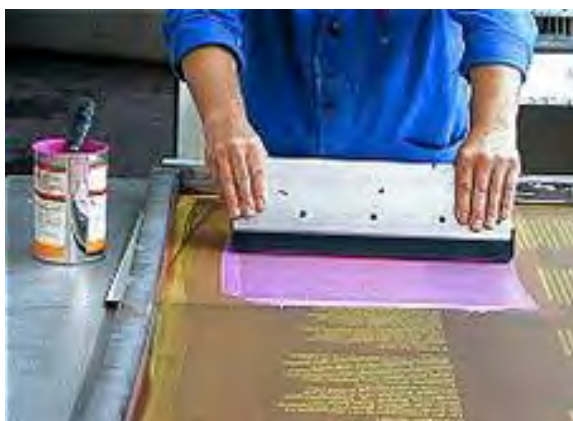
شکل ۴-۶ راکل کشیدن روی توری
