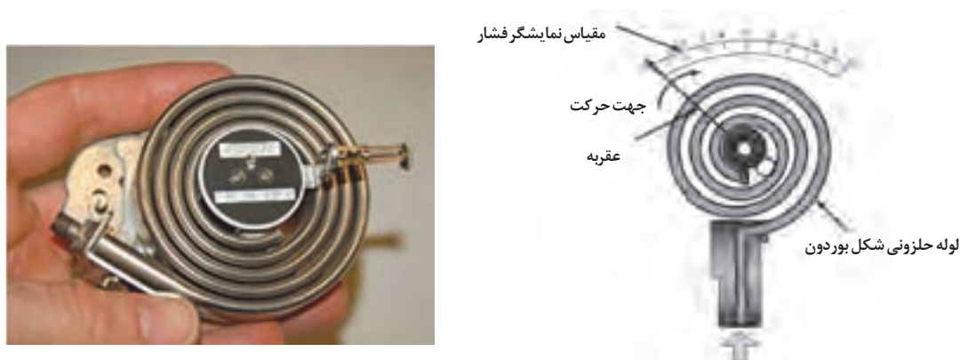
شکل ۲۱- لوله بوردون از نوع مارپیچی یا حلزونی
