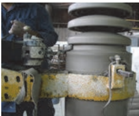
شکل ۵- شکل‌دهی قطعات سرامیکی به روش تراش
