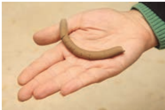
شکل ۱۵- بررسی فتیله در روش آتبرگ
