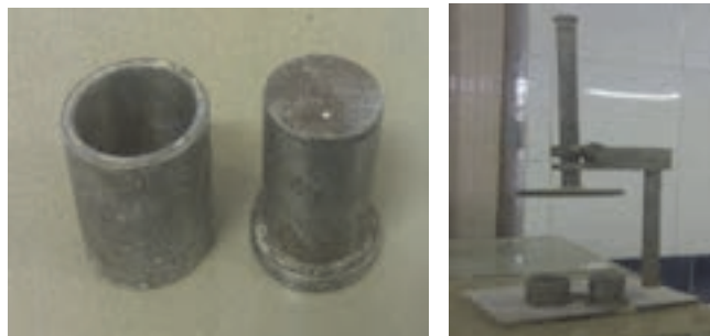
شکل ۱۷- دستگاه ففرکورن و قالب نمونه‌ساز
