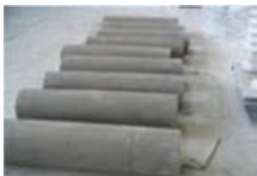
شکل ۲۰- برش شمش با طول مناسب
