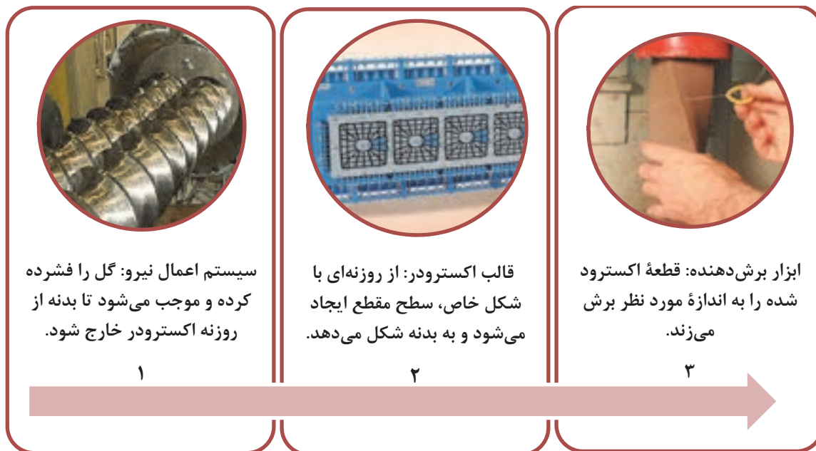
شکل ۶- اجزاء ماشین اکسترودر
