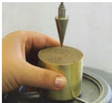
شکل ۴- دستگاه‌های کاربردی برای تعیین پلاستیسیته
