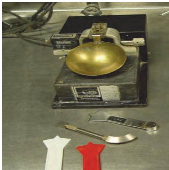
شکل ۱۴- جام کاساگرانده و شیارزن
