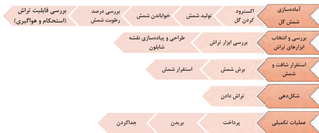
شکل ۷- مراحل شکل‌دهی گل پلاستیک به روش تراش
