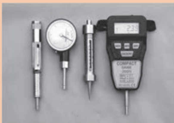
شکل ۳۱- انواع دستگاه‌های نفوذسنج
