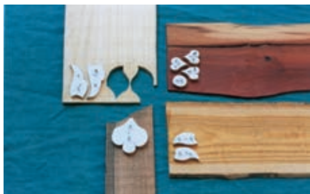
تصویر ۱۸- ۱۰- ۲- الگوها روی لایه های چوبی به وسیله چسب یا میخ سایه الصاق شده است.
