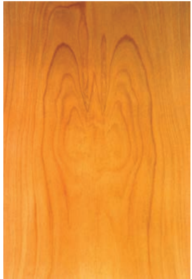
تصویر ۱-۵-۲۱ نقش چوب در برش لوله‌ای - چوب ملج
