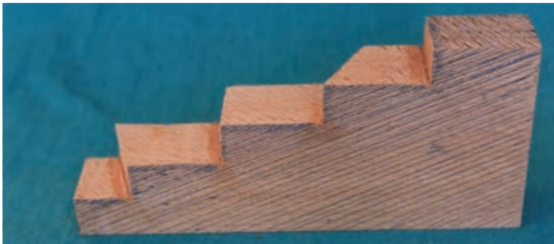
تصویر ۳-۱۱-۳ بعد از تراش قسمتهای «الف و ب و ب و ت» حجم نهایی به این صورت خواهد شد. لازم است دیواره‌ها و کف کاملاً صاف و عمود به هم تراش شود.
