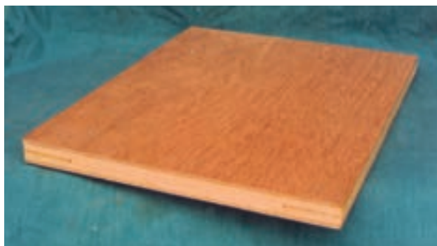
تصویر ۲-۶-۱۱- زیرساخت کلافی آماده شده بعد از پرس زوایا و لبه های زیرساخت به وسیله رنده اصلاح شده است.
