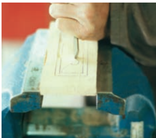
تصویر ۳-۹-۵- نحوه دورگیری به وسیله مغار تخت
