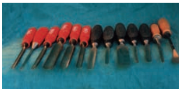
تصویر ۹-۳-۵- الف- انواع مغار گلوبی بسته- نیم باز- باز نمای روبه رو
