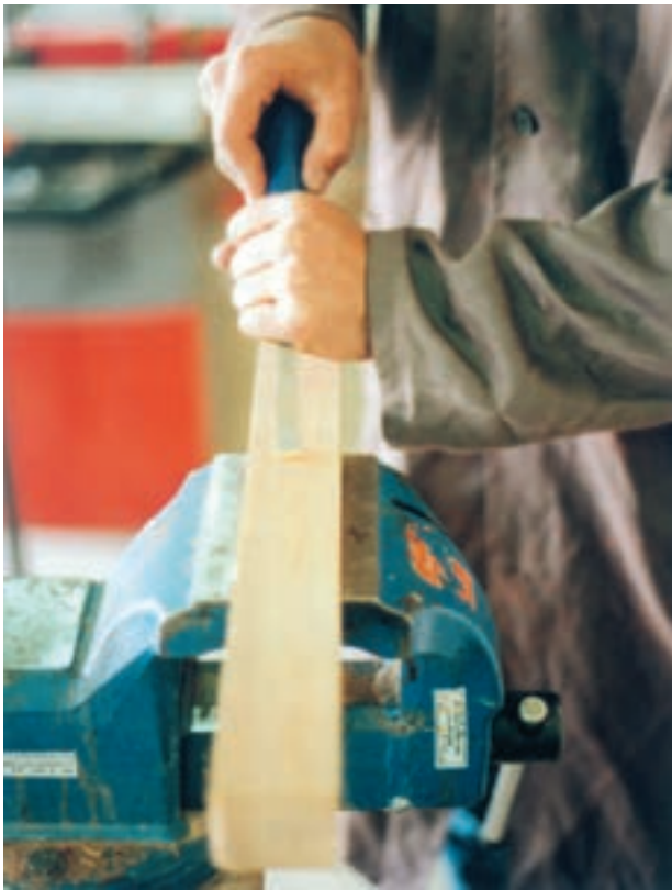
تصویر ۱-۳-۱- یک نمونه از نحوه مهار نمودن قطعه چوب مورد کنده کاری به وسیله گیره طرز صحیح گرفتن مغار با دو دست (یک دست دسته مغار، یک دست وسط تیغه مغار)
