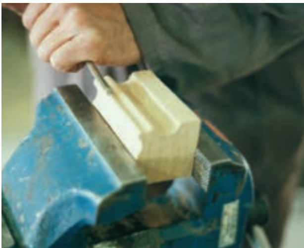
تصویر ۳-۱۰-۶ نمونه دیگری از تراش کانالهای ناودانی به وسیله مغار گلوبی بسته
