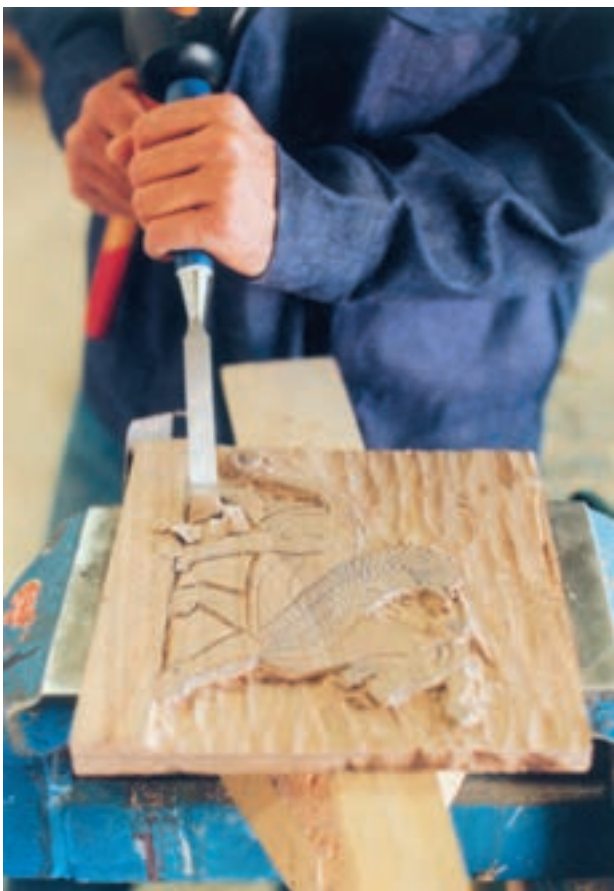
تصویر ۳-۱۵-۹- کندن زمینه به وسیله مغار تخت
