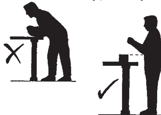
تصویر ۲-۳-۵- نحوه تنظیم ارتفاع گیره به روی میز کار برای تسلط بیشتر. ارتفاع رویه گیره برابر با زیر آرنج دست، بهترین نتیجه را می‌دهد.
