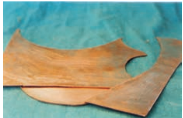
تصویر ۴-۶-۲- چند نمونه ورق مس به ضخامت دو میلیمتر که می‌تواند به همراه چوبها در معرق به کار رود.
