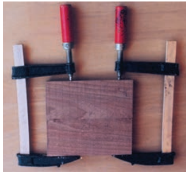
تصویر ۱-۱۵-۳- ساخت زیرساخت، درز کردن دو تخته ضخیم از پهلوی
