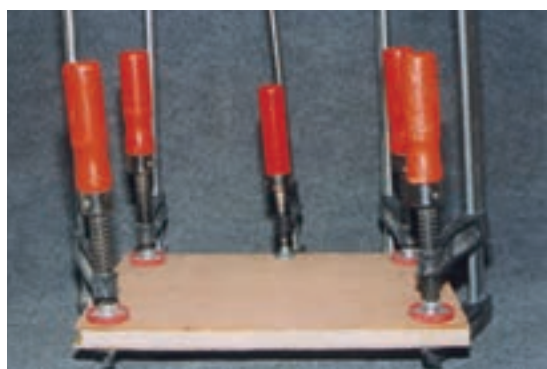
تصویر ۲-۶-۱۰- شیوه چسباندن (پرس) سه لایه در دو طرف کلاف به وسیله گیره دستی
