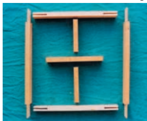
تصویر ۲-۶-۸- قطعات آماده شده برای ساخت کلاف تابلو
