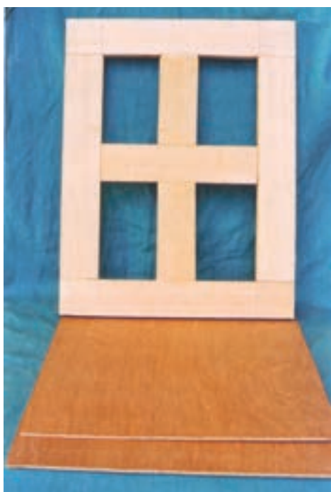
تصویر ۲-۶-۹- کلاف آماده شده و دو عدد سه لایه که بر پشت و روی آن چسبانیده می شود.
