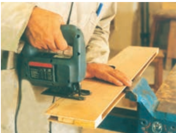
تصویر ۱-۴-۱- روش درست بکارگیری ابزارهای برقی متحرک
