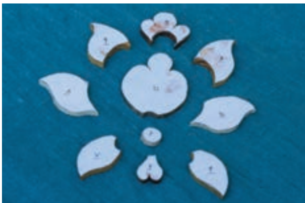
تصویر ۸- ۱۰- ۲- قطعات بریده شده برای اطمینان از برش در کنار هم قرار می گیرند.
