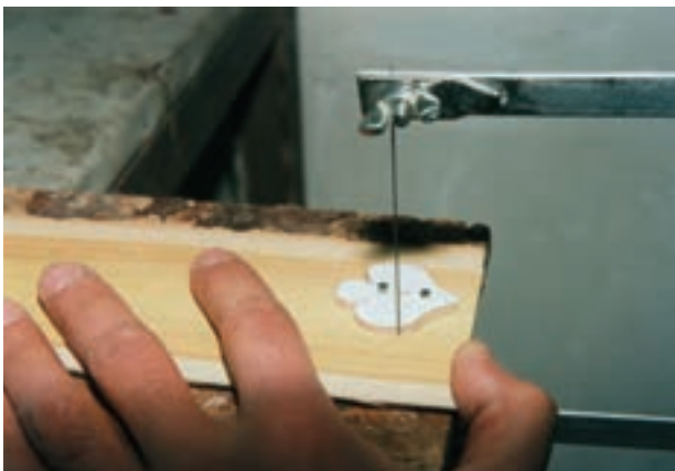
تصویر ۱۵ - ۱۰ - ۲ - برش مصالح براساس الگوی تخته سه لایی، چنانچه ملاحظه می شود تیغه اهره مماس به الگو لایه را برش می دهد.
