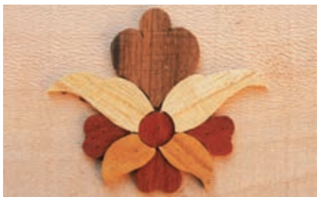
تصویر ۲۰- ۱۰- ۲- بعد از جدا نمودن الگوها قطعات در کنار هم روی یک سطح صاف چسبانده شده اند.
