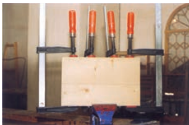
تصویر ۲-۶-۲- نحوه درز کردن دو تخته از پهلو برای دستیابی به زیرساخت بزرگتر
