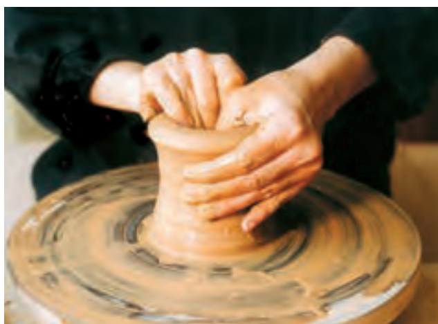
تصویرهای ۱۴ و ۱۵- گشاد کردن دهانه استوانه
