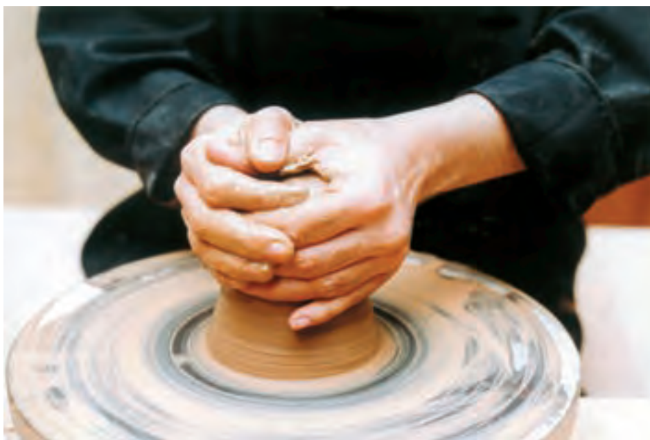
تصویر ۱۲- مسطح کردن سطح فوقانی استوانه توپُر
