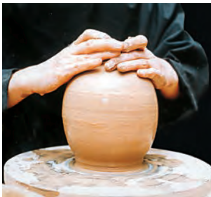
تصویرهای ۴۴ و ۴۵- جمع کردن و شکل دادن گردن کوزه
