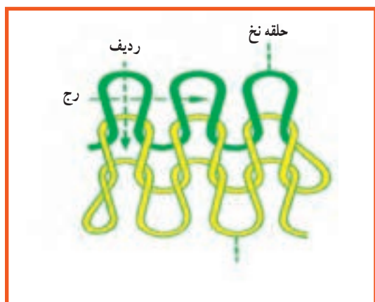
شکل ۸-۹- ساختار پارچه حلقوی پودی
