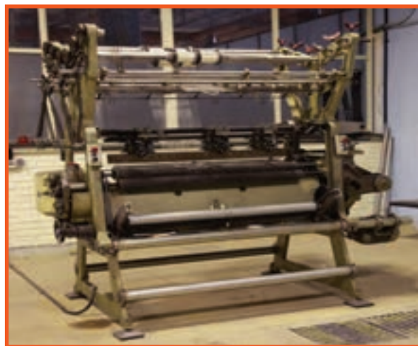
شکل ۹-۱۰- ماشین بافندگی حلقوی تاری
