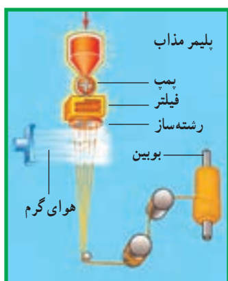
شکل ۱۰-۶- مراحل تولید نخ یک سره
