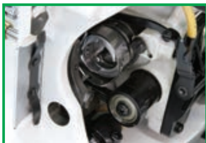
شکل ۶-۸ — ماسوره، ماکو و قاب ماکو
