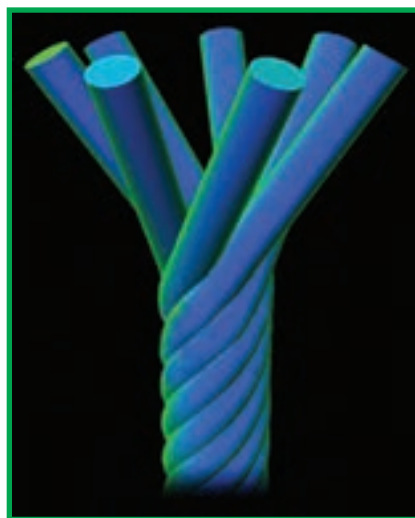
شکل ۶-۶- نحوه تابیدن الیاف به دور یکدیگر
