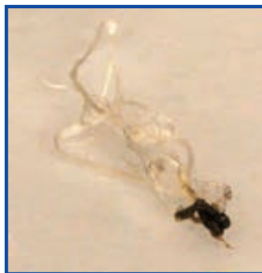
شکل ۵-۳- خاکستر حاصل از سوختن نخ نایلونی
