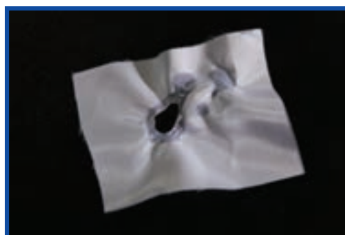
شکل ۴-۱۰ اثر استن بر پارچه استات
