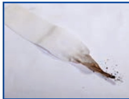
شکل ۴-۹ خاکستر حاصل از سوختن پارچه استات
