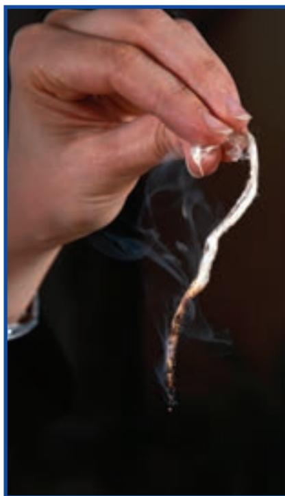
شکل ۳-۱۵- سوختن الیاف ابریشم
