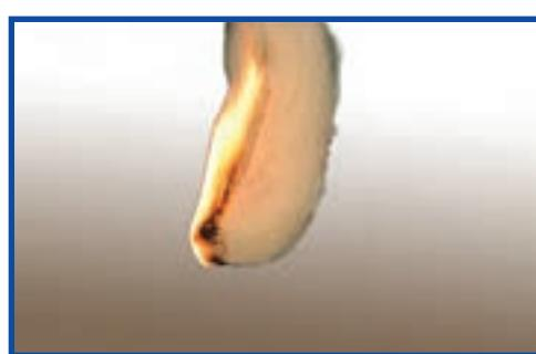
شکل ۳-۶- سوختن الیاف پشم
