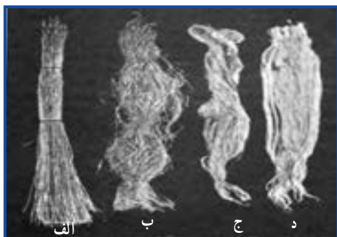
شکل ۱۹-۲- مراحل استخراج الیاف کتان از ساقه گیاه
