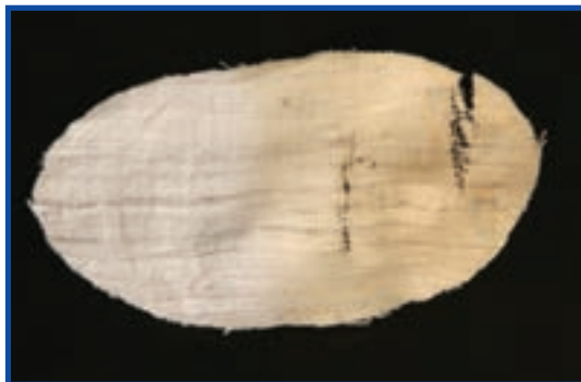
شکل ۲-۶- تجزیه پارچه پنبه‌ای در دمای ۱۵۰ درجه سانتی‌گراد
