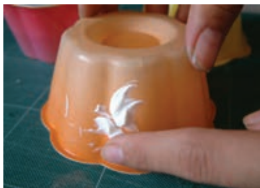
۱- زدن ماده جداکننده به مدل
