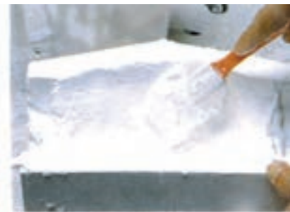
۱۶- گچ را درون قالب یک دست کنید.
