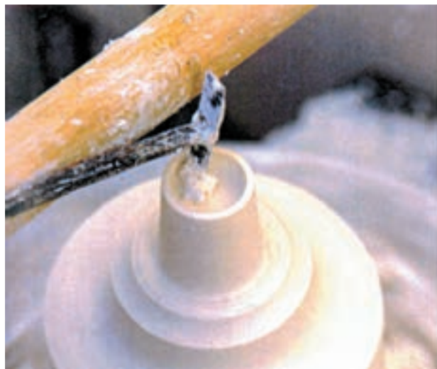
۸- تراش داخلی با استفاده از تکیه‌گاه
