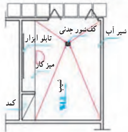
شکل ۲۷-۳ - پلان شیب بندی و کف شور یک پارکینگ
