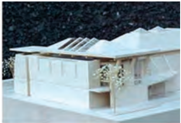
شکل ۶۱-۲- از ماکت برای نمایش و طراحی فضاهای داخلی و حجم بیرونی استفاده می‌شود.
