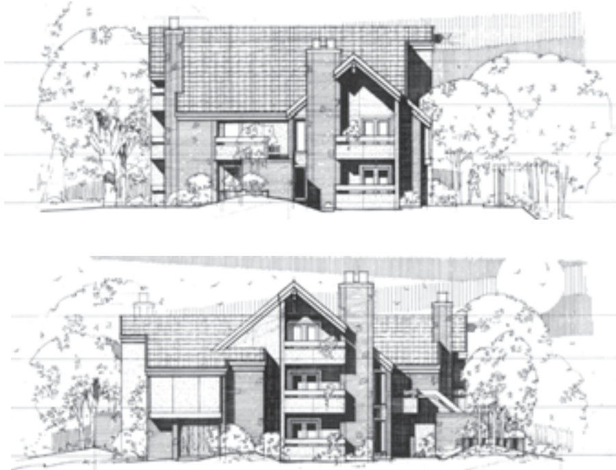
شکل ۲-۴۰- ارائه‌ی نما با استفاده از سایه روشن نما و بافت مصالح
