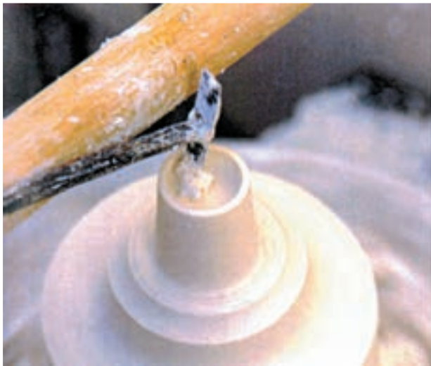
۸- تراش داخلی با استفاده از تکیه‌گاه
