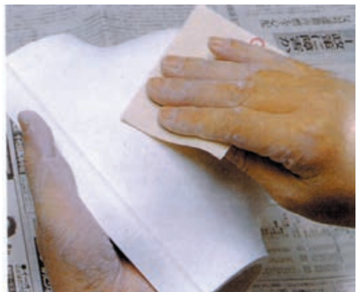
۲۰- سطح خارجی قطعه را پس از خشک شدن به آرامی با یک تکه سنباده بسابید.
