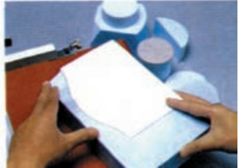
۲- مونتاژ قطعات فومی ساخته شده
